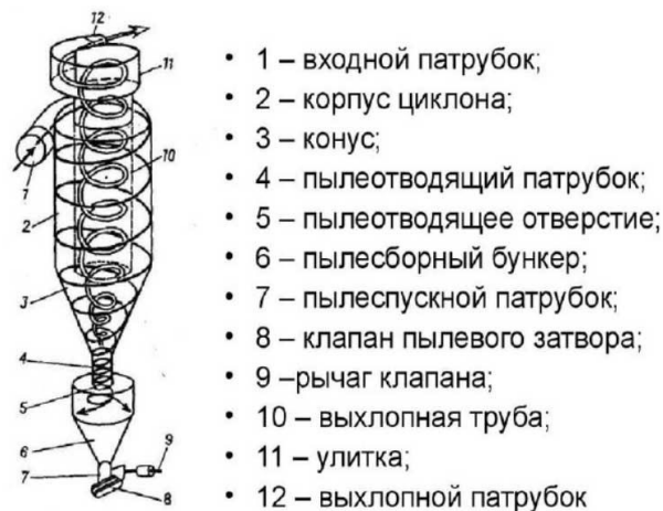
Рис. 2. Схема золоуловителя циклон производство «Факел»
