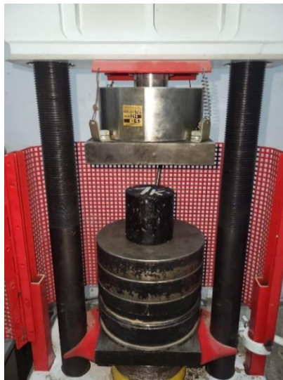
Рис. 2. Определение предела прочности
