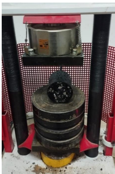
Рис. 3. Испытание прочности при расколе
