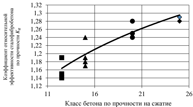
Рис. 5. Зависимость коэффициента K_R от класса бетона по прочности на сжатие
