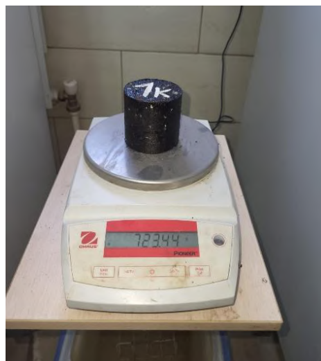
Рис. 1. Взвешивание подготовленных образцов на воздухе
