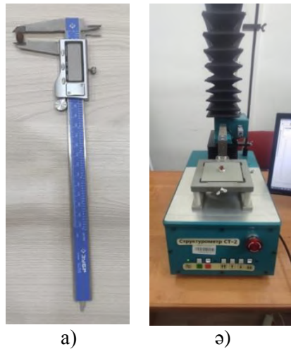
Сурет 1. Электронды штангенциркуль (а) және структурометр СТ-2 (б)
