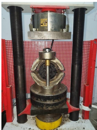
Рис. 4. Проведение испытания на сдвигоустойчивость образцов
