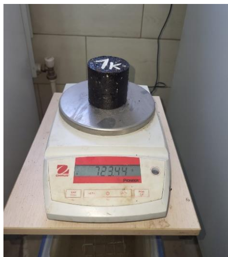
Рис. 1. Взвешивание подготовленных образцов на воздухе
