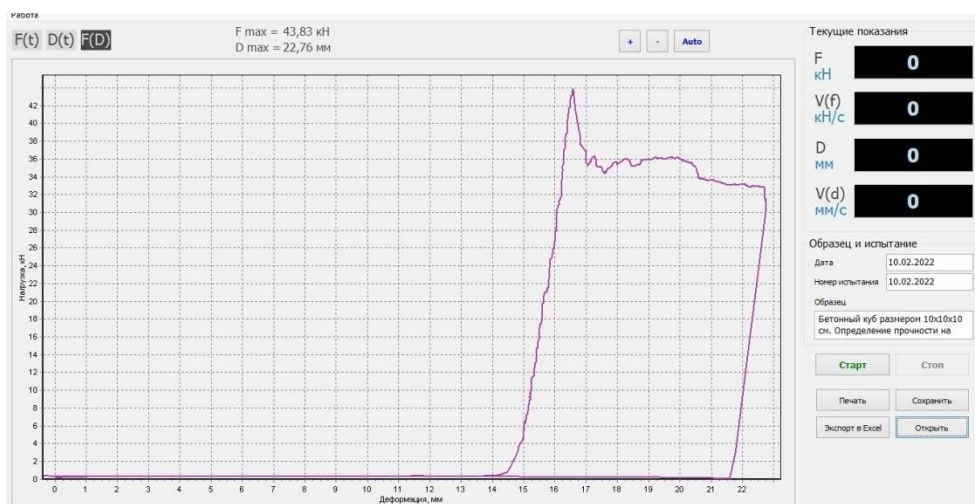
Сурет 3. Дисперсті арматураланған газ бетонның сығылғандағы шекті деформацияның жүктемеге байланысты өзгеруі
