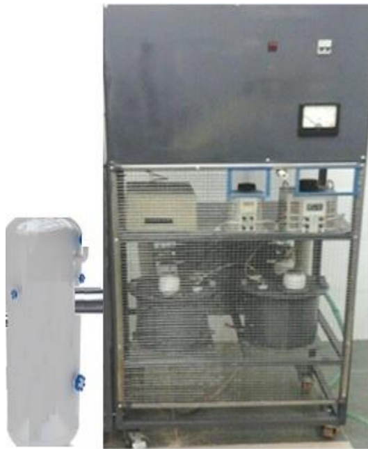
1 сурет. Сусымалы материалдар мен сұйық қоспаларды өңдеу бойынша әмбебап өнеркәсіптік ионизондау қондырғысы
