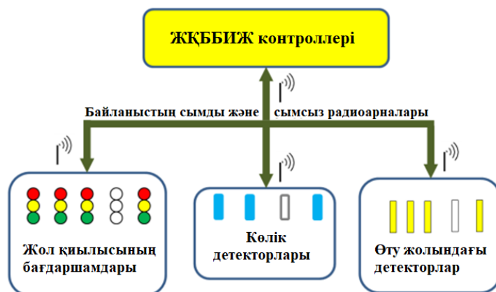
Сурет 3. Жол қиылысындағы бағдаршам жұмысын басқарудың интеллектуалды жүйесі (ЖҚББИЖ) функционалдық схемасы
