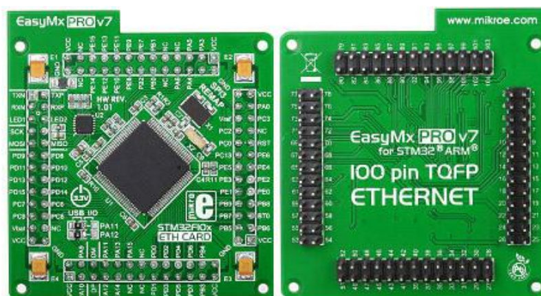
Рис. 2. Специализированная карта микроконтроллера с микроконтроллером по умолчанию STM32F107VCT6: лицевая и обратная стороны
