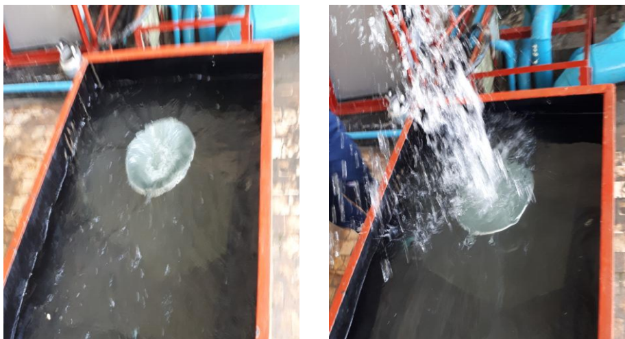
Сурет 3. Шахталы су тастағыштың қабырғаларсыз кіреберісінің жұмысы
