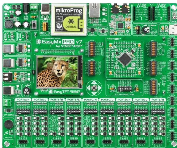
Рис. 1. Полнофункциональная отладочная плата EasyMx PRO v7 for STM32 Development System
