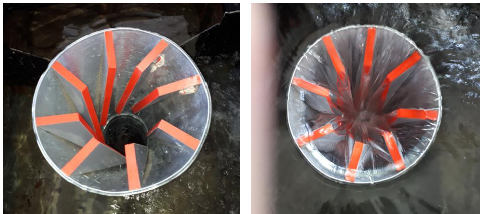
Сурет 5. Шахталық су тастағыштың қабырғалары воронканың жазық бетіне 70-75° жанама орналасқан кіреберіс бөлімі
