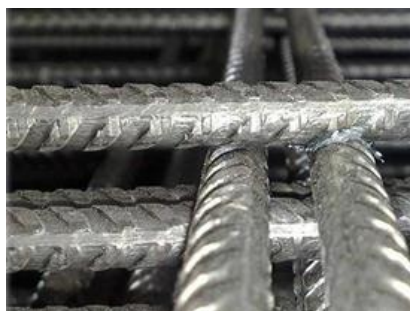
Сурет 3. Айқастырып біріктірілген тор сымдарының металл қаңқасы
