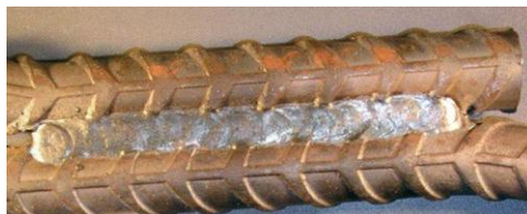
Сурет 1. Арматураны қабаттастырып дәнекерлеумен біріктіру
