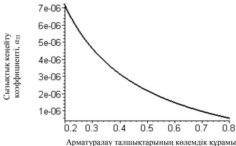
Сурет 2. Композиттің \alpha_{33} сызықтық кеңею коэффициентінің арматуралау талшығының көлемдік құрамына тәуелділігі
