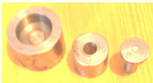
Рис. 3. Общий вид матрицы, цилиндра и поршня пресс-формы
