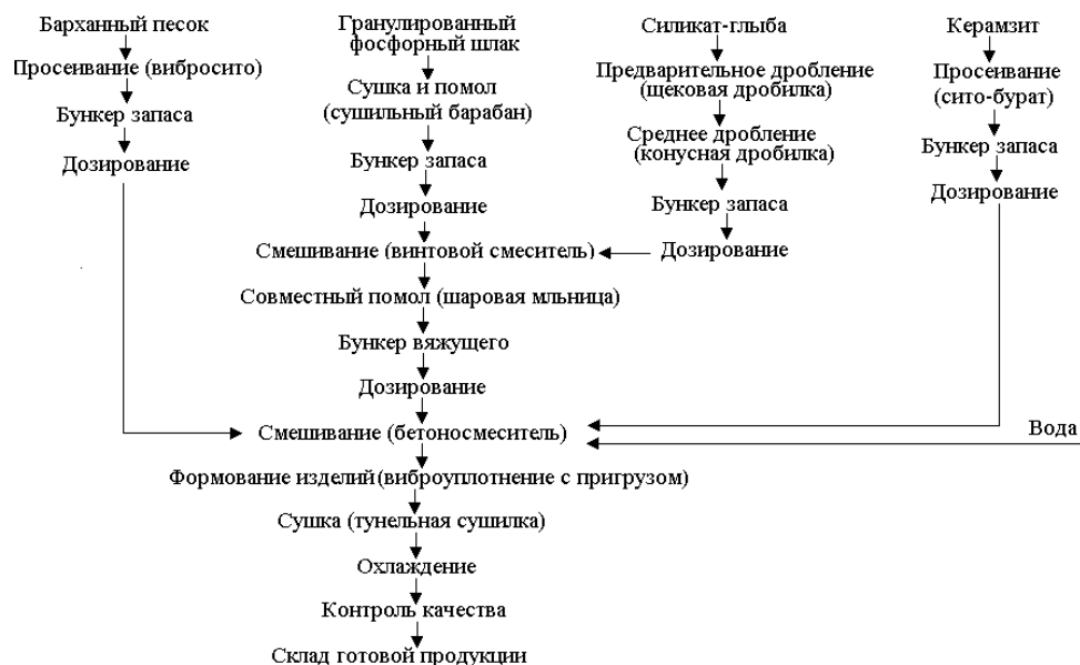
Рис. 1. Технологическая схема производства стеновых изделий.
