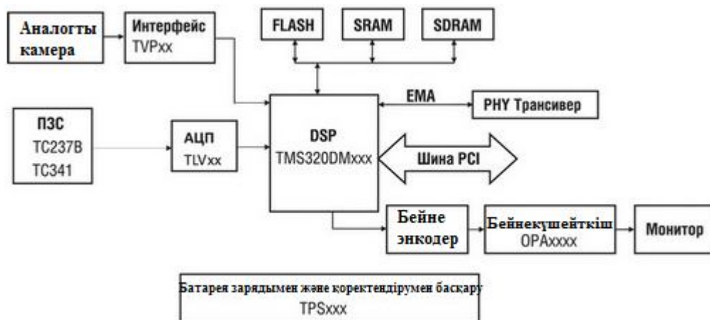
Сурет 4. Бетті тану негізінде қолжетімділіктің биометриялық жүйесінің блок-сұлбасы
