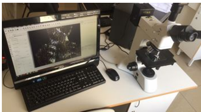
Рис. 2. Универсальный металлографический микроскоп Альтами МЕТ 5Т
