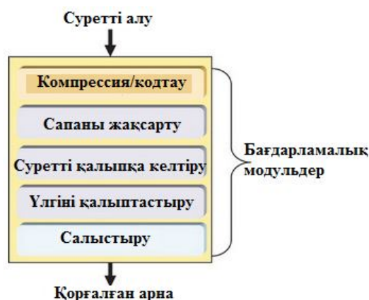
Сурет 2. DSP құрылғының жұмыс алгоритмі
