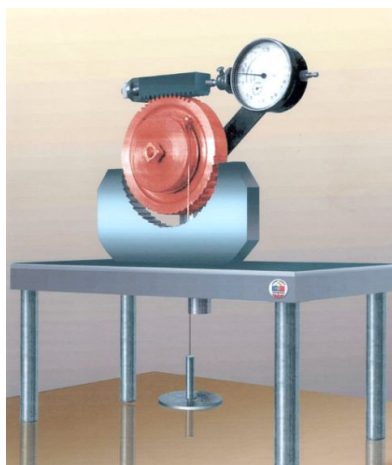
Сурет 2. Тұтқырлығы жоғары тамақ материалдарының реологиялық қасиеттерін анықтауға арналған пластометрдің жалпы түрі
