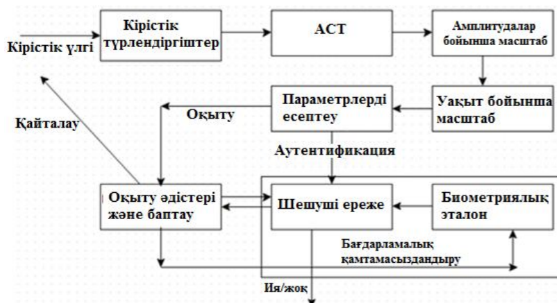
Сурет 1. Динамикалық сипаттамалар негізінде жеке тұлғаның биометриялық идентификация жүйелерінің жалпы блок-сұлбасы
