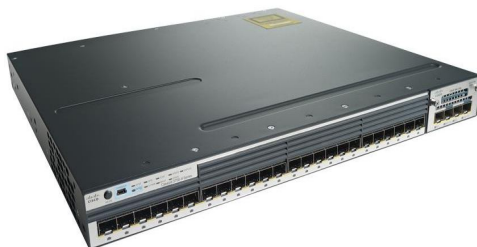
Сурет 2. Cisco Catalyst WS-C3750X-24S-S коммутаторының сыртқы түрі
