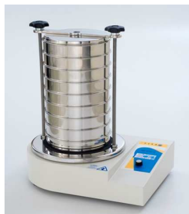
Рис. 2. Установка лабораторная для разделения песчаной основы формовочных песков на фракции по крупности зерен (Модель 029)
