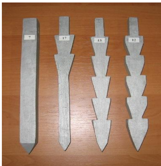
Рис.1. Общий вид моделей свай с разной формой продольного сечения
