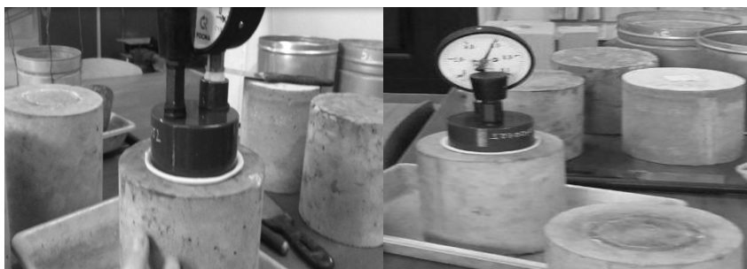
Сурет 1. VV-2 құрылғысы мен бетонның суға төзімділігін сынау
