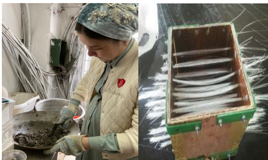
Сурет 2. Лабораториялық жағдайда мөлдір бетон араласпанын дайындау
