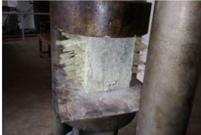
Сурет 3. Мөлдір бетонның сығуға беріктігін сынау
